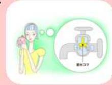
当施設につけている節水コマは、通常の水量の3割カットです。デモ期間を経て業務に支障がなく使用できるということで、3割カットできる節水コマを取り付けました。設置以降、1週間当たり約30 tの節水効果を確認しています。
